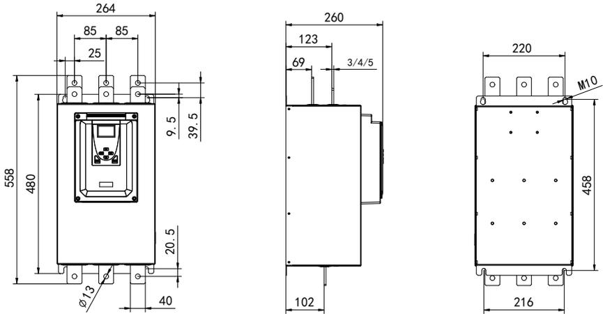
Figure 2.4 90kW~200kW (Units:mm)
