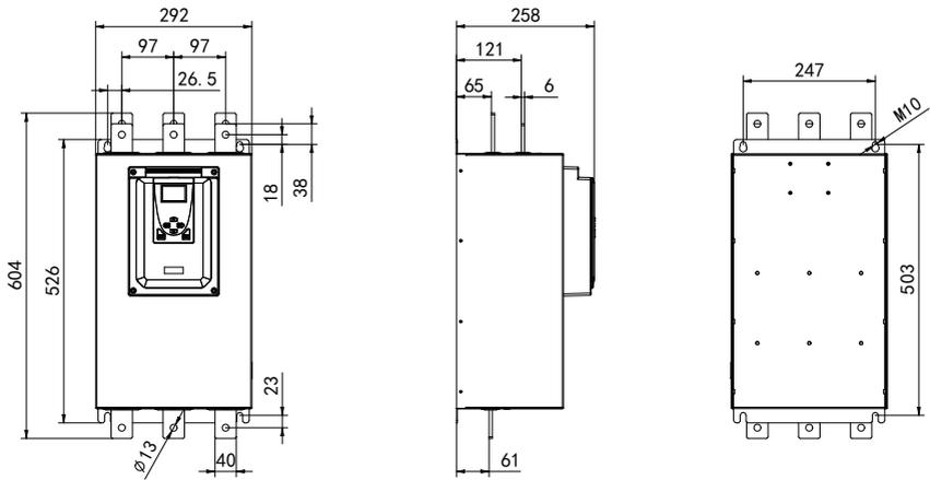
Figure 2.5 250kW~320kW (Units:mm)
