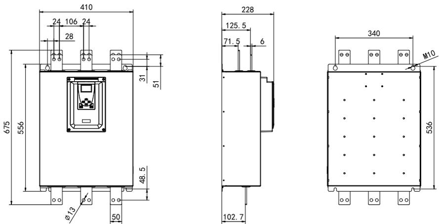
Figure 2.6 400kW~500kW (Units:mm)
